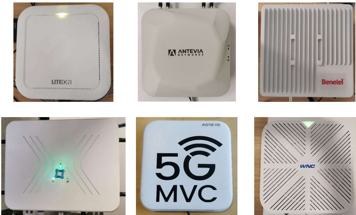
Bilder: Exempel på kommersiella radioenheter (RU) i vårt labb
